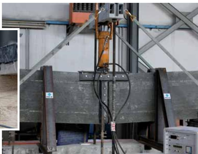
Solaio JPCT prova a taglio orizzontale
