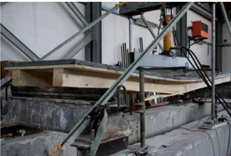
La rottura del solaio JPCT
