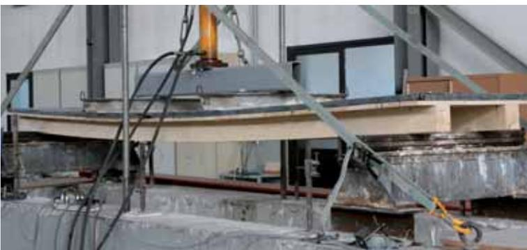
Solaio JPCT prima della rottura
