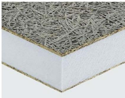
Pannello isolante termico ed acustico composito, costituito da due strati (sp. 5 mm ciascuno) in lana di legno di abete rosso mineralizzata e legata con cemento Portland grigio, accoppiato ad uno strato interno di polistirene espanso estruso, conforme alla norma UNI EN 13164. Conforme alla norma UNI EN 13168. CELENIT E3 è certificato PEFC™. Disponibile anche con certificazione FSC®.
