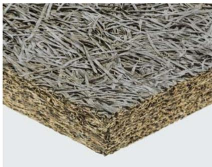
Pannello isolante termico ed acustico, in lana di legno di abete rosso mineralizzata e legata con cemento Portland grigio. Larghezza lana di legno: 3 mm. Conforme alla norma UNI EN 13168. Certificato da ANAB-ICEA e natureplus per la ecocompatibilità dei materiali e del processo produttivo. CELENIT N è certificato PEFC™. Disponibile anche con certificazione FSC®.
