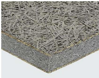
Pannello isolante termico ed acustico composito, costituito da due strati (sp. 5 mm ciascuno) in lana di legno di abete rosso mineralizzata e legata con cemento Portland grigio, accoppiato ad uno strato interno di polistirene espanso sinterizzato additivato con grafite, conforme alla norma UNI EN 13163. Conforme alla norma UNI EN 13168. CELENIT G3 è certificato PEFC™. Disponibile anche con certificazione FSC®.
