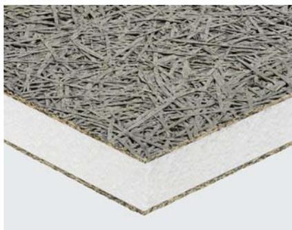
Pannello isolante termico ed acustico composito, costituito da due strati (sp. 5 mm ciascuno) in lana di legno di abete rosso mineralizzata e legata con cemento Portland grigio, accoppiato ad uno strato interno di polistirene espanso, conforme alla norma UNI EN 13163. Conforme alla norma UNI EN 13168. CELENIT P3 è certificato PEFC™. Disponibile anche con certificazione FSC®.
